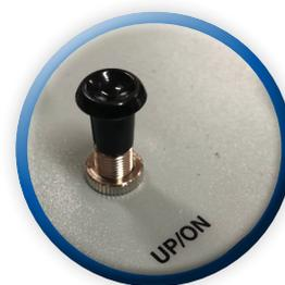
Der Knopf, mit dem der Impuls eingestellt wird, darf niemals gegen den Uhrzeigersinn gedreht werden. Also immer im Uhrzeigersinn drehen.
